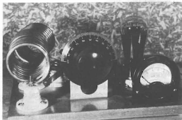
TX del 1930: UV 210 oscillatrice Hartley, 15 W CW.
